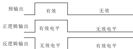
图7-15 数字输出端子正反逻辑输出示意图
